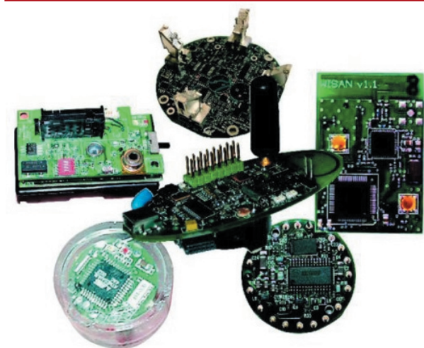
FIGURA 1 ► Alcune tipologie di nodo per reti di sensori.
