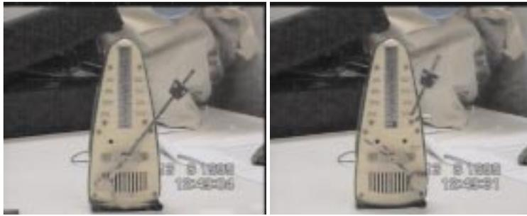
**Abbildung 3.** Bild 1: erste Übertragungsfehler bei 8.57 MBit/s Bandbreite für Video-Daten und einem Lastverkehr von 139.5 MBit/s; Bild 2: grobe Übertragungsfehler bei 7.18 MBit/s Bandbreite für Video-Daten, Lastverkehr von 141 MBit/s
